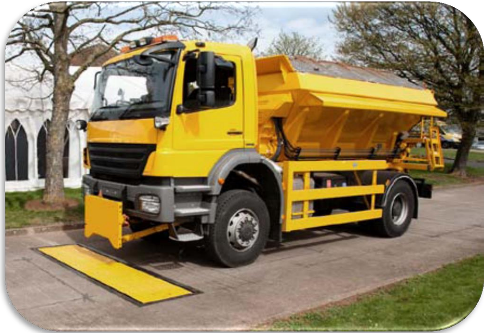
Cân tải trọng trực xe để bảo vệ đường
